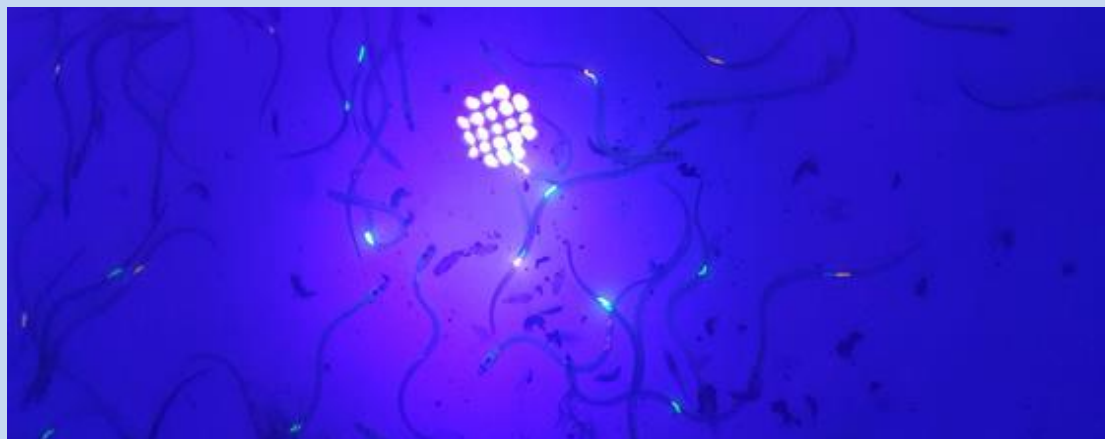
Figuur 4 Om de effectiviteit van een vispassage voor glasaal te onderzoeken wordt er gebruik gemaakt van gekleurd merkjes (VIE-tags) 5, 7 & 8 Foto: Mark Groen.
